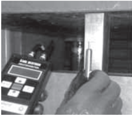
شکل ۷ - نحوه اندازه گیری میدان مغناطیسی پسماند در نمونه شماره ۲ تحت شرایط بارگذاری محوری
