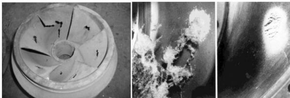
سمت چپ: رفتار کاویتاسیون در حین حرکت سیال سمت راست: تخریب کامل پروانه
