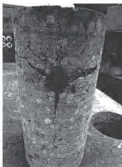
شکل ۶. ترک های ناشی از انقباض آرماتور داخل بتن
