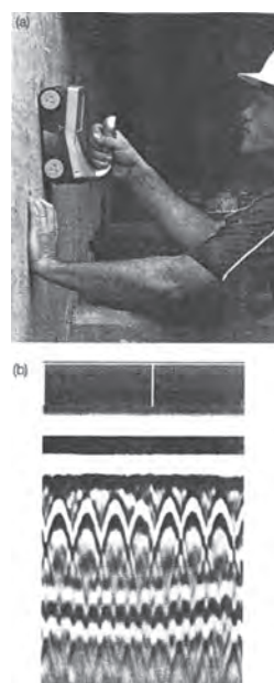
شکل ۹. سیستم GPR دستی مجهز به رادار و نمایشگر (a) دستگاه در حال کار (b) تصویر دریافتی
