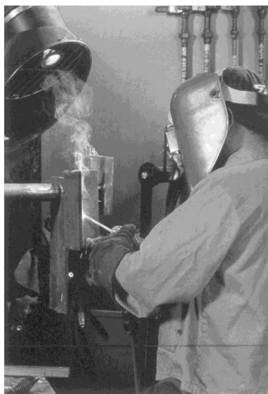
شکل (۹) - سیستم تهویه متحرک که نزدیک قوس جوشکاری قرار گرفته است
